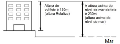
A figura introduz a altura relativa e altura acima do nível do mar. altura absoluta indica a altura acima do nível do mar. altura relativa indica a diferença de altura entre dois locais diferentes.
